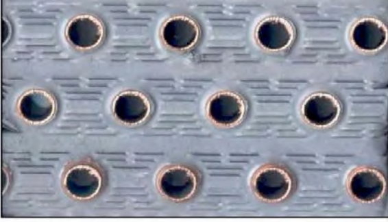
ŞEKİL 9: TUZ PÜSKÜRTME TESTİNDEN SONRA BLYGOLD POLUI KAPLANMIŞ ISI EŞANJÖRÜ
