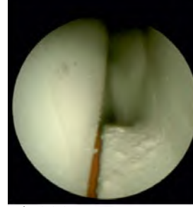
ŞEKİL 5: İPLİKSI KOROSYON, ÖNCEDEN KAPLANMIŞ ALÜMİNYUM
