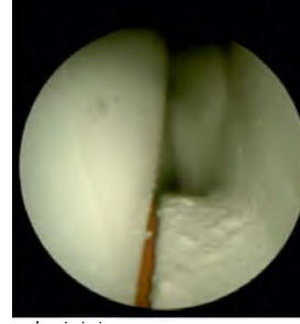
ŞEKİL 5: İPLİKSI KOROSYON, ÖNCEDEN KAPLANMIŞ ALÜMİNYUM
