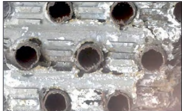
ŞEKİL 1: 500 SAATLİK ASİT TUZ PÜSKÜRTME TESTİNDEN SONRA ISI EŞANJÖRÜ DETAYI
