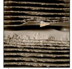
ŞEKİL 6: KANAT KENARI KOROSYONU, ÖNCEDEN KAPLANMIŞ ALÜMİNYUM
