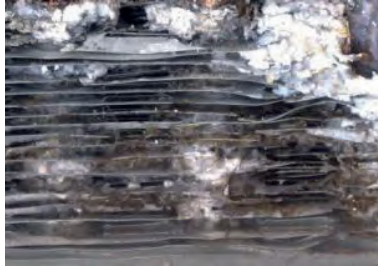
11.000 SAAT TUZ PÜSKÜRTME TESTİNDEN SONRA KORUNMASIZ EŞANJÖR
